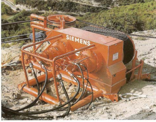
Boğa tekerin iki likit motorla sürülmesi
