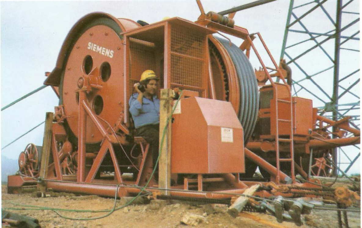
180 kN (18 ton) boğa teker çekme makinesi (tensioner)
